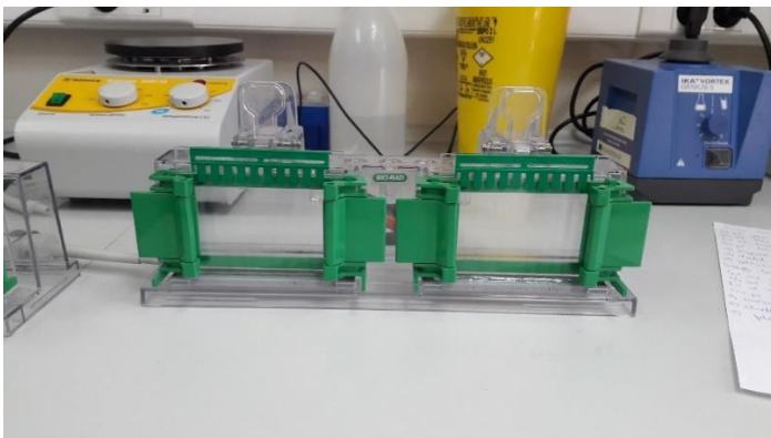
Slika 3. Sustav za polimeriziranje gelova kod elektroforeze (fotografirala autorica rada)
