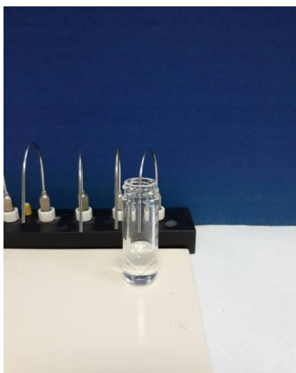
Slika 8: Uparavanje organskoga dijela nakon ekstrakcije (fotografija autorice)
