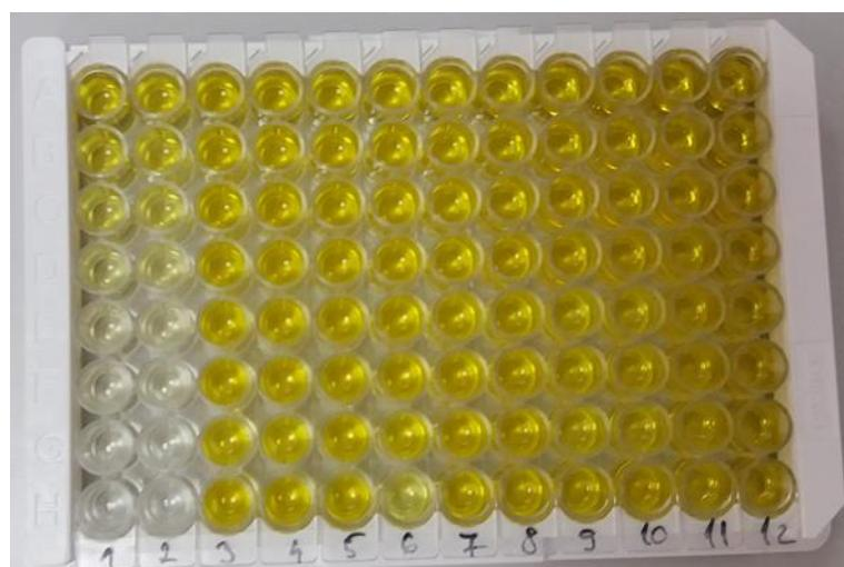
**Slika 5.** Test-pločica u koji je dodan uzorak i sekundarno protutijelo
