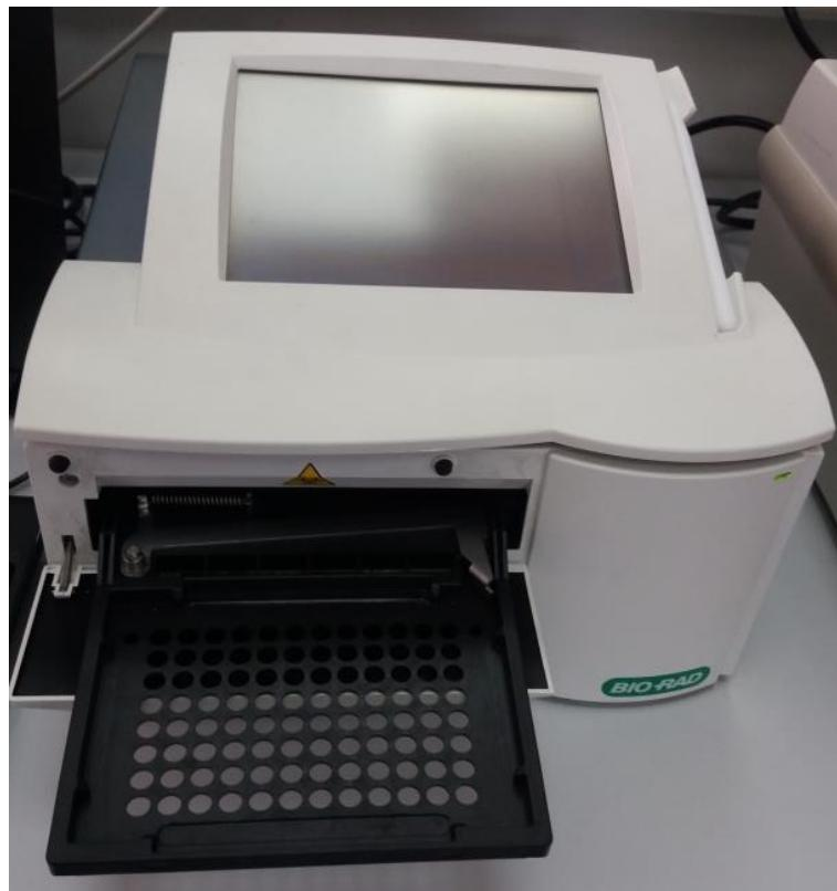
**Slika 8.** Spektrofotometrijski mjerač apsorbance s ladicom za test-pločicu
