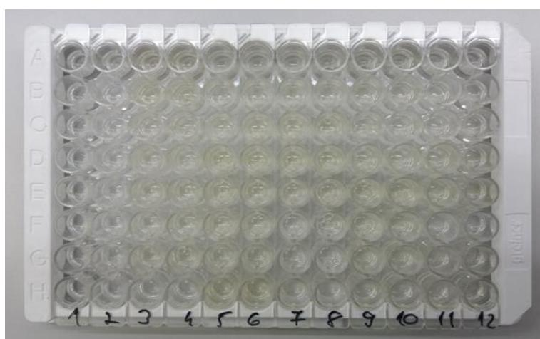
**Slika 3.** Test-pločica s imobiliziranim specifičnim protutijelima
