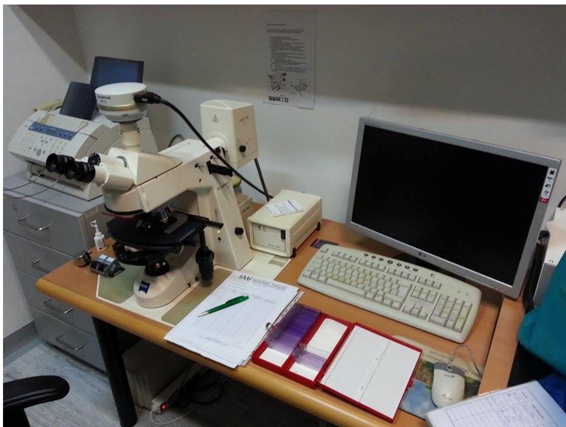
Slika 4. Svjetlosni mikroskop Axioskop 2 MOT Zeiss i računalo sa DP Controller programom za slikanje
