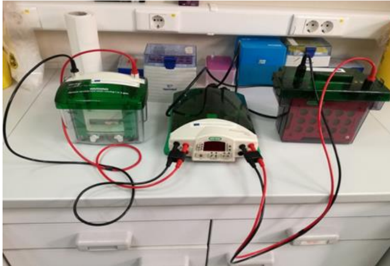
Slika 3. Sustav za elektroforezu s kadicom za prijenos proteina s gela na membranu (izvor: original autorice rada)
