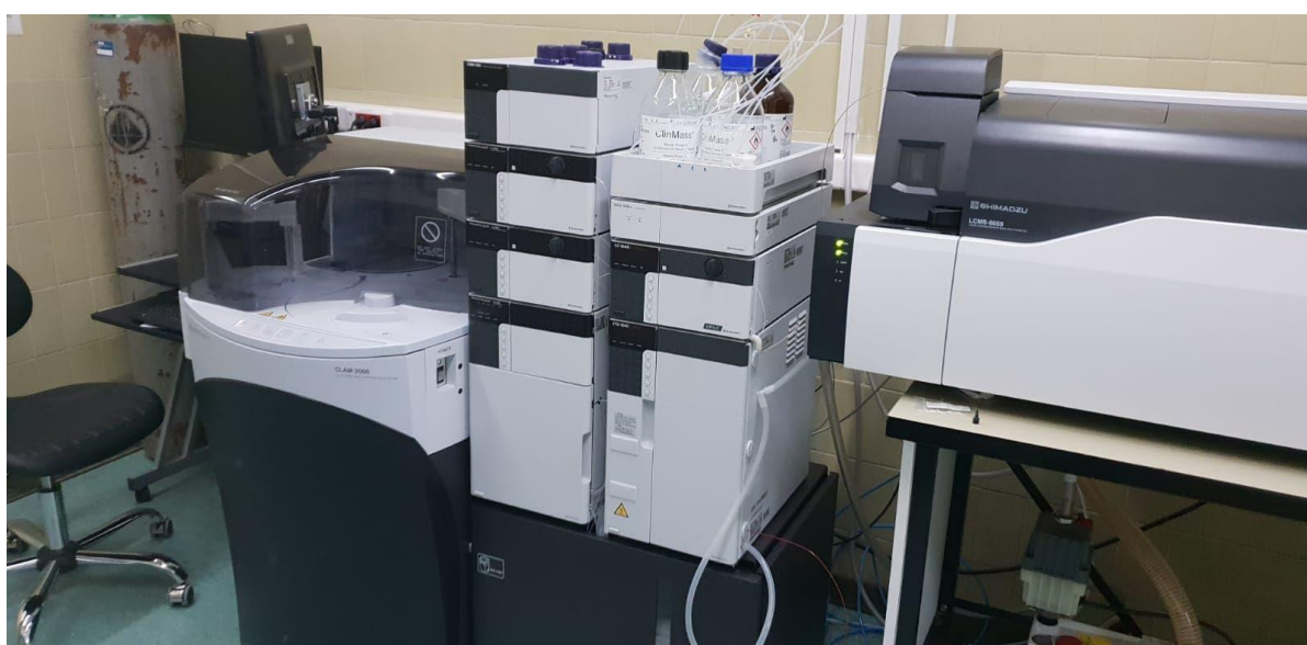
Slika 4. Prikaz uređaja NEXERA X2 HPLC koji je povezan sa LCMS-8050.
