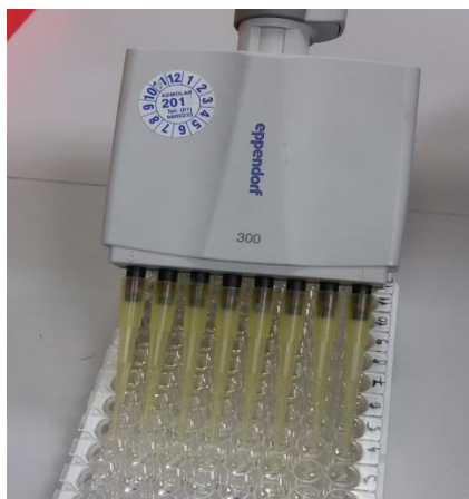
Slika 4. Pipetiranje uzoraka i reagensa na testnu ploču prema uputama proizvođača (fotografirala autorica)
