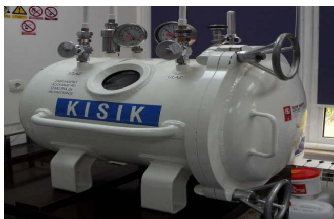
Slika 1. Hiperbarična komora (izvor: original autorice rada)
