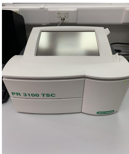
Slika 2. Čitač mikrotitarskih pločica (ELISA) – BioRad 93200 PR3100 TSC (izvor: original autorice rada)
