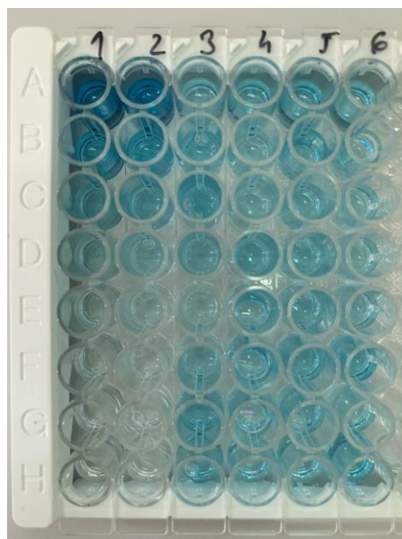
Slika 3. ELISA pločica na kojoj je vidljiva standardna krivulja (1 i 2) i uzorci (3-6) (izvor: original autorice rada)
