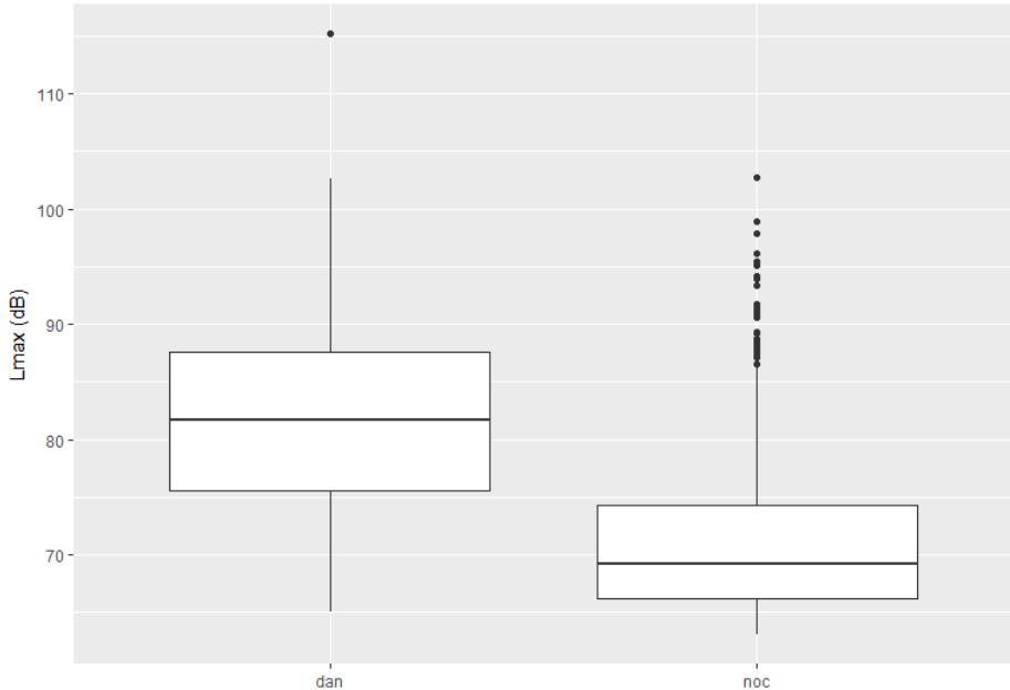
Slika 5.3. Usporedba razina  $L_{max}$  između dnevnih i noćnih razdoblja
