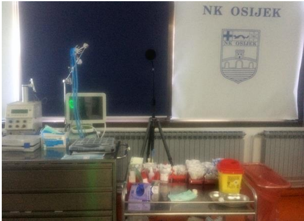
Slika 4.7. Pozicioniranje mikrofona zvukomjera na tronošcu u prostoriji Zavoda za neonatologiju i neonatalnu intenzivnu medicinu
