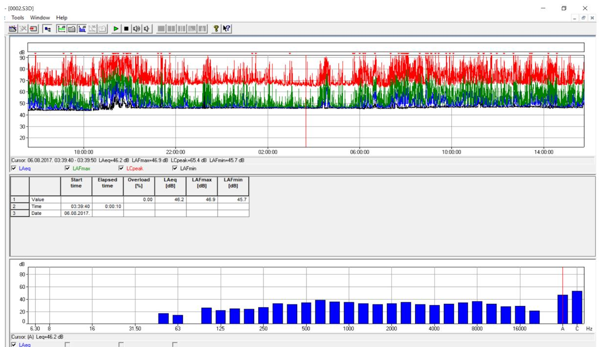
Slika 4.8. Primjer rezultata analize snimanja buke u prostoru tijekom jednog mjerjenja
