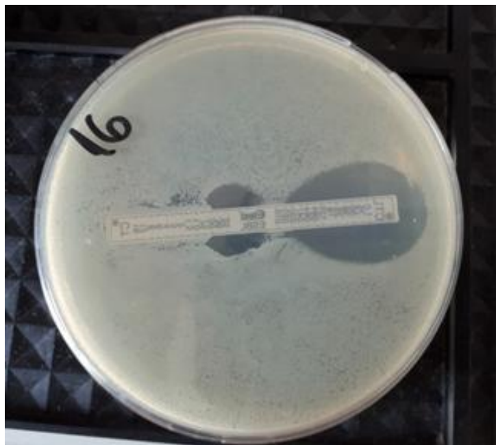
Slika 5.8. E-test ESBL na M-H agaru
