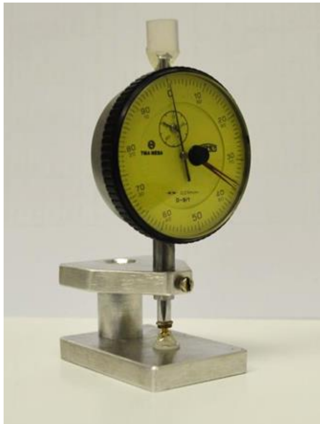
Slika 4.23. Uređaj za mjerenje debljine plodovih ovoja
