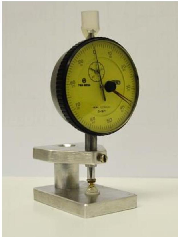
Slika 4.23. Uređaj za mjerenje debljine plodovih ovoja
