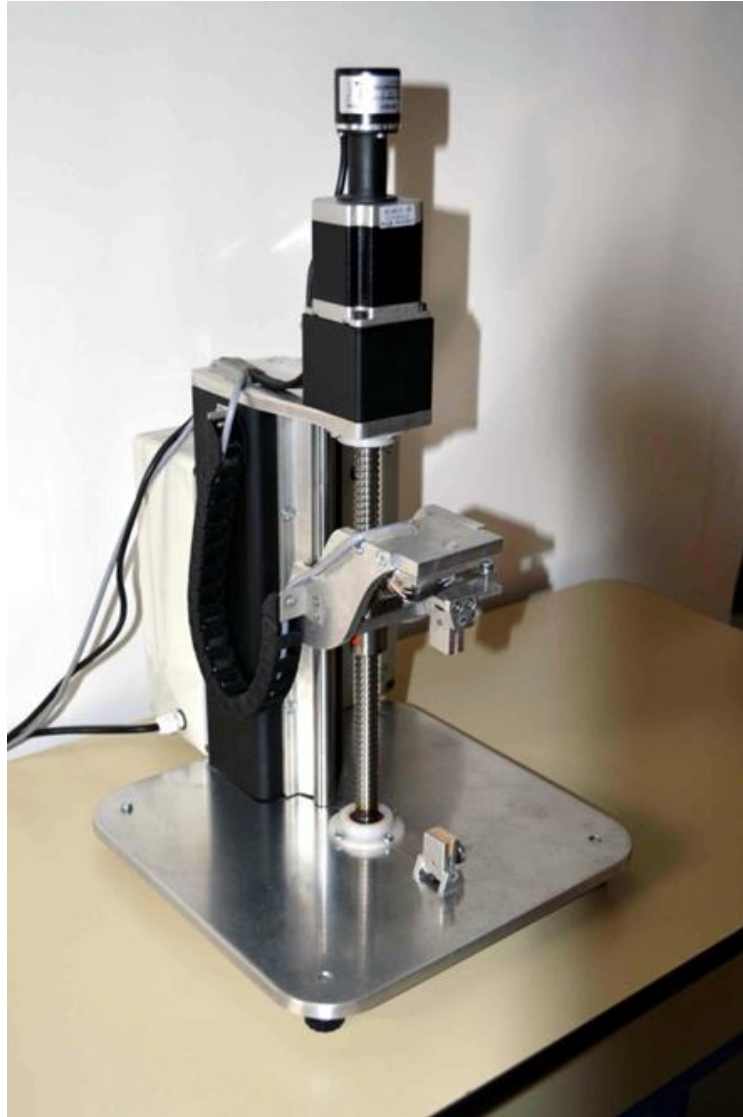
Slika 4.9. Uređaj za vlačni pokus pri ispitivanju plodovih ovoja
