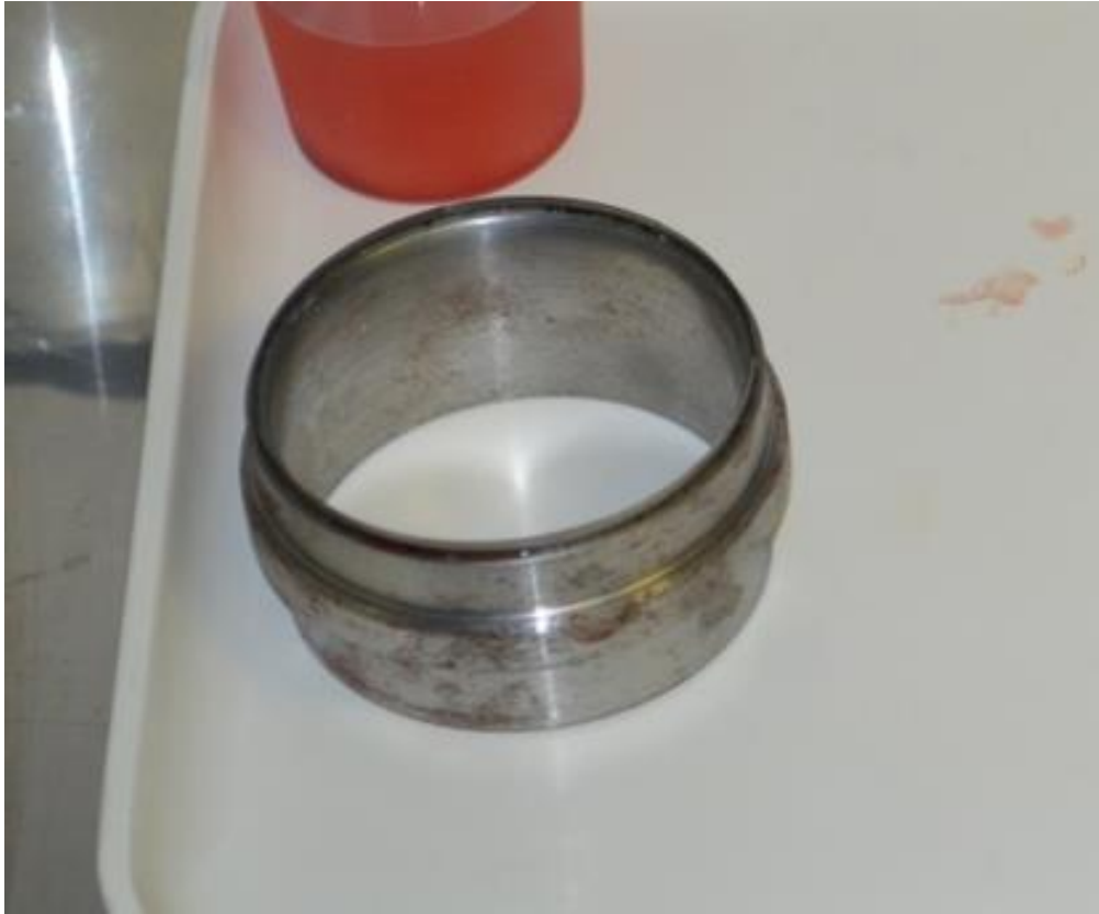
Slika 4.5. Nož za izrezivanje uzoraka za dvoosna ispitivanja
