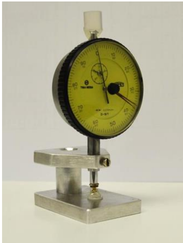
Slika 4.23. Uređaj za mjerenje debljine plodovih ovoja
