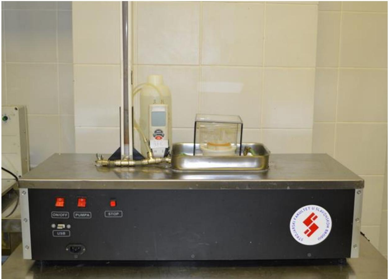
*Slika 4.18. Uređaj za ispitivanje plodovih ovoja hidrauličkim udublivanjem – pogled
