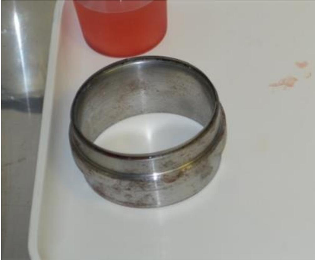
*Slika 4.5. Nož za izrezivanje uzoraka za dvoosna ispitivanja*
