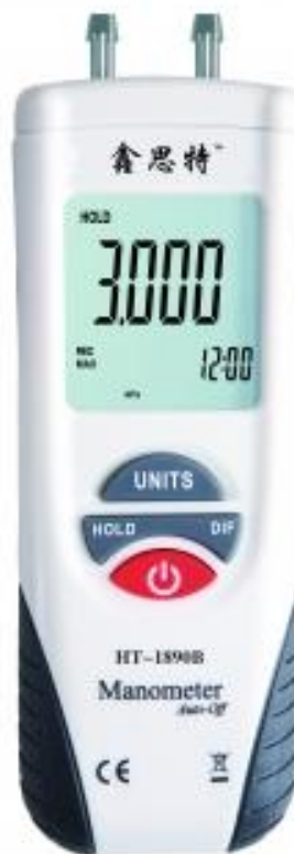
Slika 4.21. Digitalni manometar korišten za registriranje tlakova pucanja pri klasičnom i cikličnom dvoosnom ispitivanju
