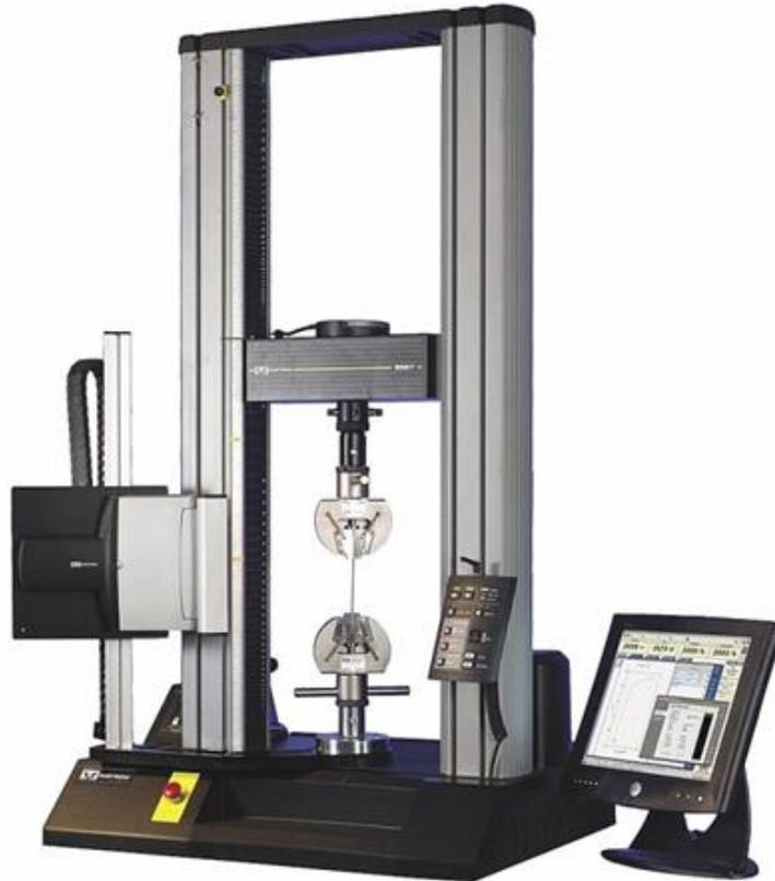
*Slika 4.6. Tipičan elektromehanički uređaj za vlačni pokus (30)*
