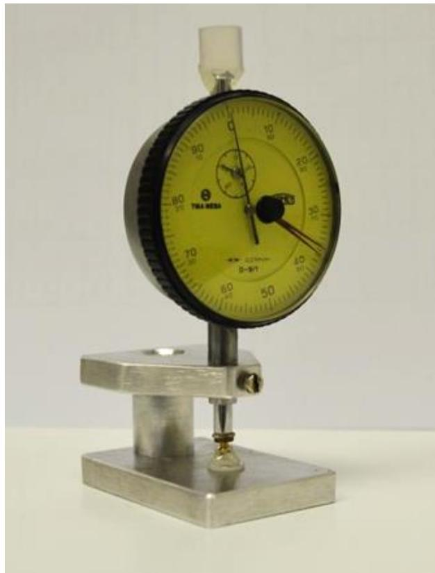
*Slika 4.23. Uređaj za mjerenje debljine plodovih ovoja*
