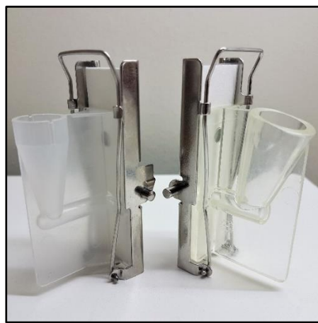
Slika 4. Nosač komorica i filter papira
