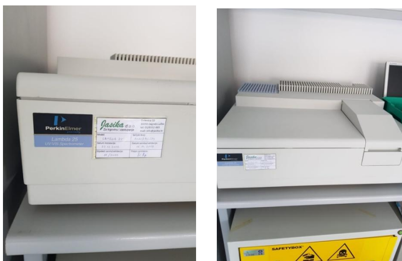
Slika 5. Perkin Elmer Lambda 25 UV/VIS spektrofotometar. (izradio autor)
