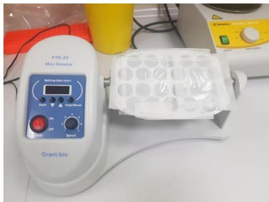
**Slika 9.** Mini Rotator na kojem se odvija inkubacija (izvor: original autorice rada)
