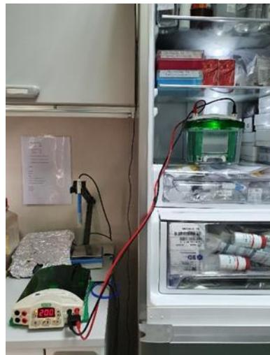
**Slika 7.** Sustav za SDS – PAGE elektroforezu na 4°C (izvor: original autorice rada)
