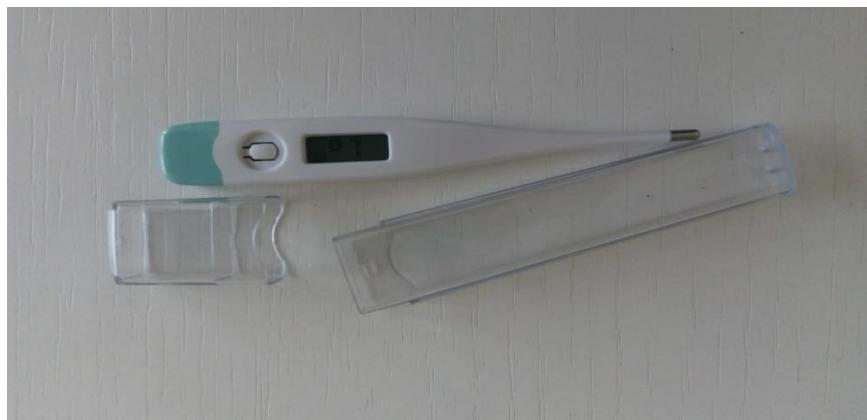
Slika 3. Digitalni termometar
