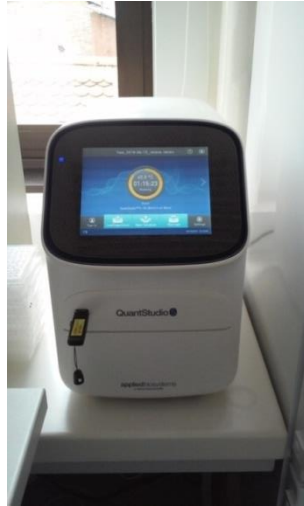
Slika 3. Uređaj QuantStudio 5 PCR
