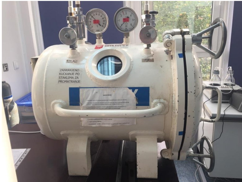
Slika 1. Barokomora , složeni medicinski uređaj unutar kojeg su zdravi Sprague-Dawley štakori bili izloženi HBO 2 (izvor: original autorice rada).
