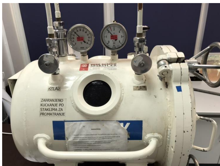
Slika 1. Hiperbarična komora za potrebe pokusa. (Izvor slike: Slikano u laboratoriju za fiziologiju i imunologiju, Katedra za fiziologiju i imunologiju Medicinskog fakulteta u Osijeku)
