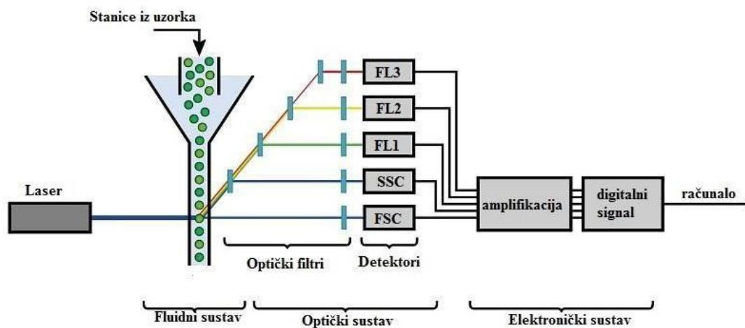
Slika 4. Sustav protočnog citometra (sliku izradio autor)
