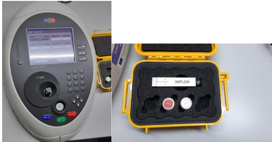
Slika 4. Implen spektrofotometar P330 (Izvor: fotografirala autorica rada)
