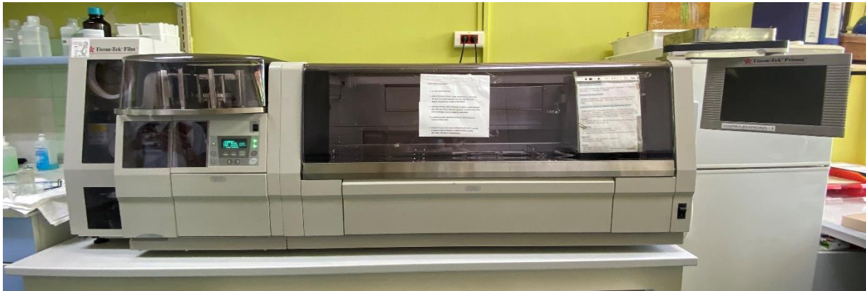
Slika 3. Aparat za automatsko bojenje i prekrivanje preparata na Kliničkom zavodu za patologiju i sudsku medicinu, KBC Osijek, „Sakura Tissue-Tek Film Automated Coverslipper“ (Torrance, California, SAD) i „Sakura Tissue-Tek Prisma Plus Automated Slide Stainer“ (Torrance, California, SAD) (Izvor: fotografirao autor rada).
