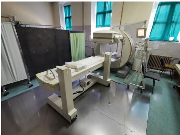
**Slika 2.** Siemens e-Cam gama kamera
