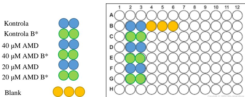
Slika 4. Shematski prikaz nasadijanja uzoraka za GSH test u pločicu s 96 jažica. B\* označava biološki duplikat. Sliku napravila autorica.
