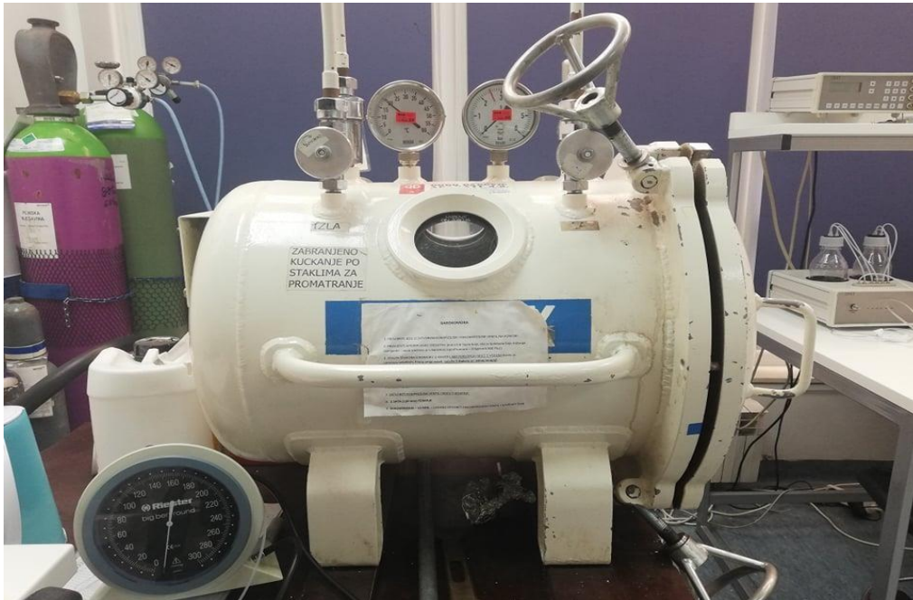
Slika 1. Rekompresijska komora za pokuse – 110 L, proizvođač Đuro Đaković, Aparati d.d., Slavonski Brod (izvor: original autorice ovog rada)
