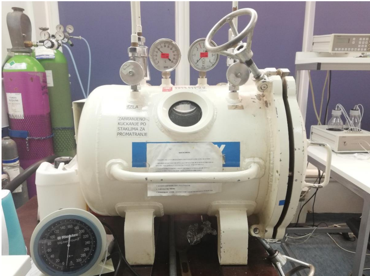
Slika 1. Rekompresijska komora za eksperimente 110L, Đuro Đaković, Aparati d.d., Slavonski Brod (izvor: original autorice rada)
