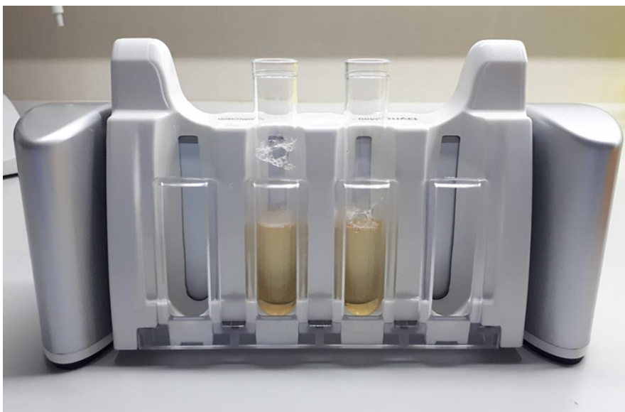
Slika 3. Odvajanje Dynabeadsa iz kulture na magnetu Dynamag 5
