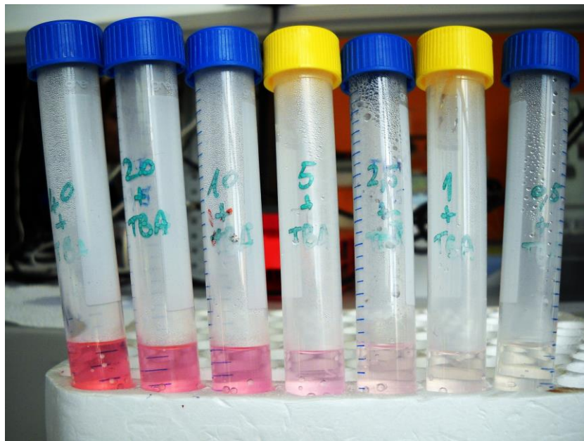
Slika 1. TBARS. Ružičasto obojenje nastalo reakcijom MDA/TBA nakon kuhanja u kupelji
