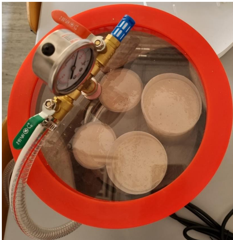
Slika 4.15. Posude s BTS stavljene u vakuumsku komoru radi evakuacije mjehurića nastalih za vrijeme procesa miješanja komponenti smjese. Na površini se može vidjeti nakupljanje mjehurića plina iz smjese. Izvor: autor rada.
