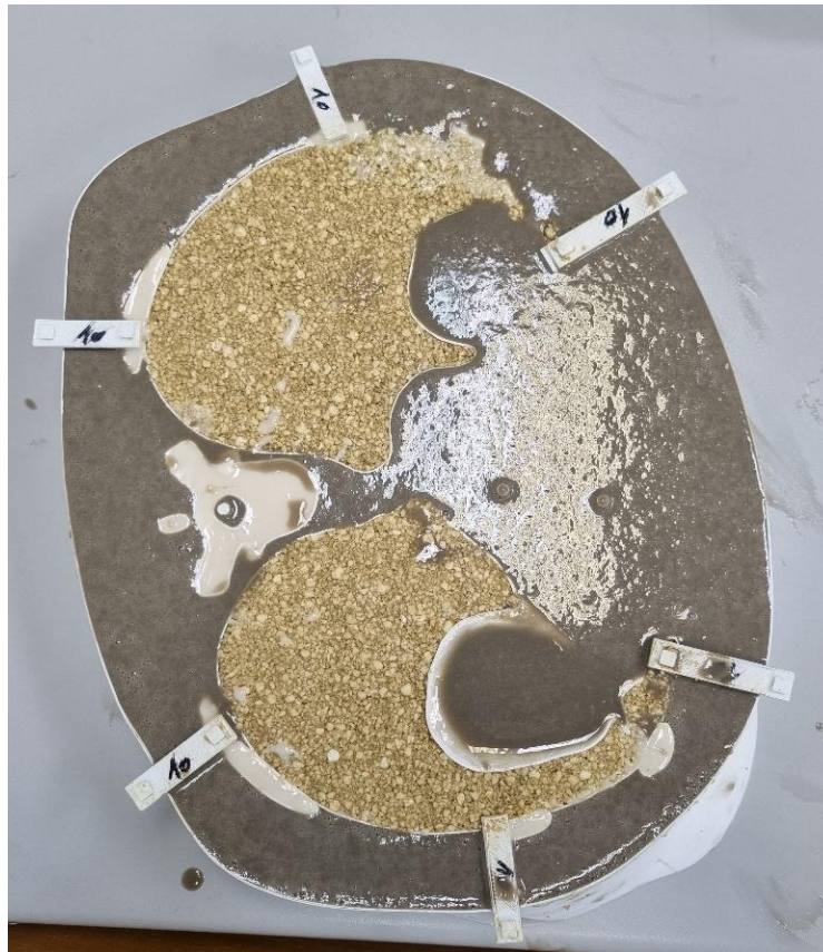
Slika 4.18. Jedan od izlivenih kalupa ostavljen na ravnoj površini i na sobnoj temperaturi 24 – 48 h radi potpune polimerizacije. Na površini uz rub kalupa mogu vidjeti se nakupljeni mjehurići zraka koje je moguće probušiti prilikom procesa polimerizacije ili izravnati površinu njenim brušenjem nakon polimerizacije. Izvor: autor rada.
