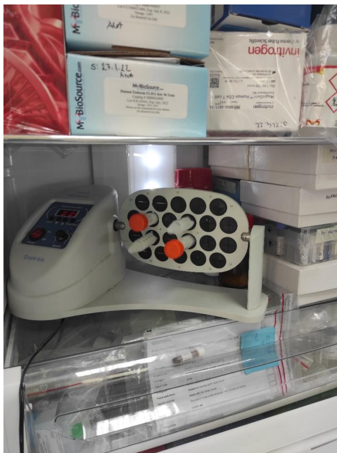
Slika 3. Inkubacija primarnih protutijela na Mini Rotatoru u hladnjaku (izvor: fotografirala autorica rada)
