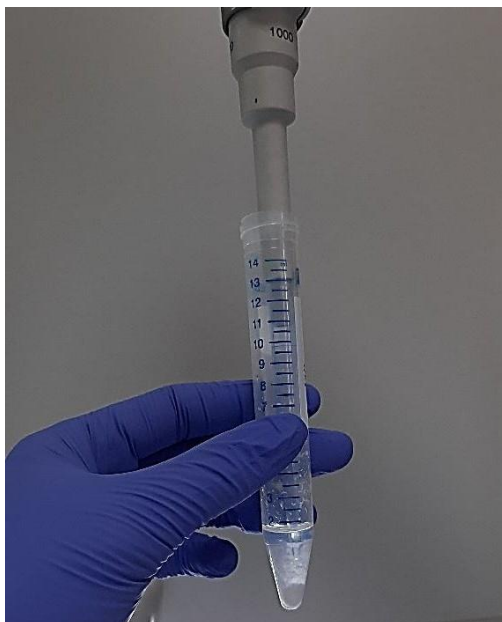
Slika 4. Odvajanje supernatanta nakon centrifugiranja za TBARS metodu (Izvor: original autorice rada)
