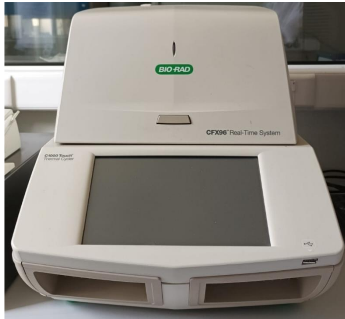
Slika 2. Bio-Rad Real Time PCR CFX96 uređaj, Laboratorij za kliničku i molekularnu imunologiju Medicinskog fakulteta u Osijeku (izvor: original autora rada).
