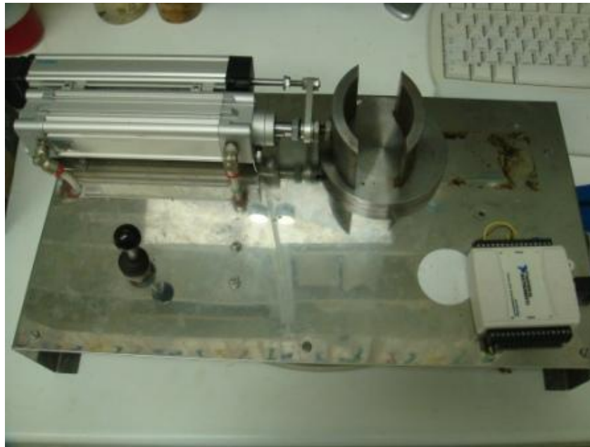
Slika 4.4. Stroj za lom štitnih hrskavica
