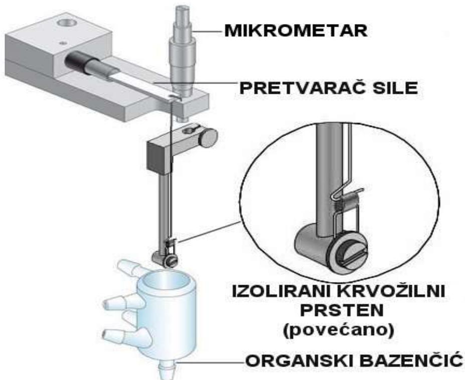
Slika 4.2. Shema sustava za izolirane aortalne prstene (145).
