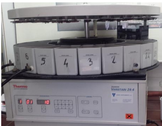
Slika 1. Aparat za bojanje po Papanicolaou (preuzeto iz fundusa Kliničkog zavoda za kliničku citologiju, KBC-a Osijek)
