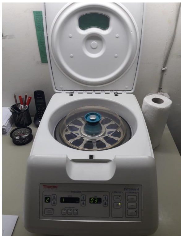
Slika 1. Uređaj za citocentrifugu
