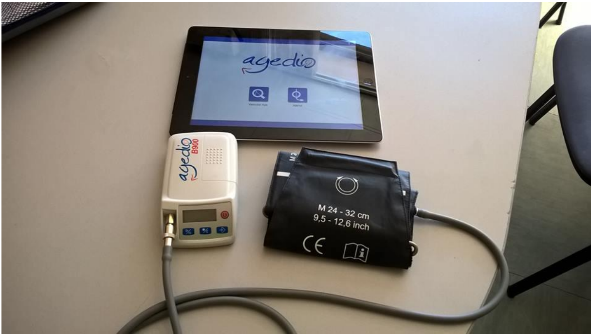
Slika 1. Uređaj „Agedio B900“. Sastoji se od „Agedio B900“ uređaja, manšete i Apple iPada.
