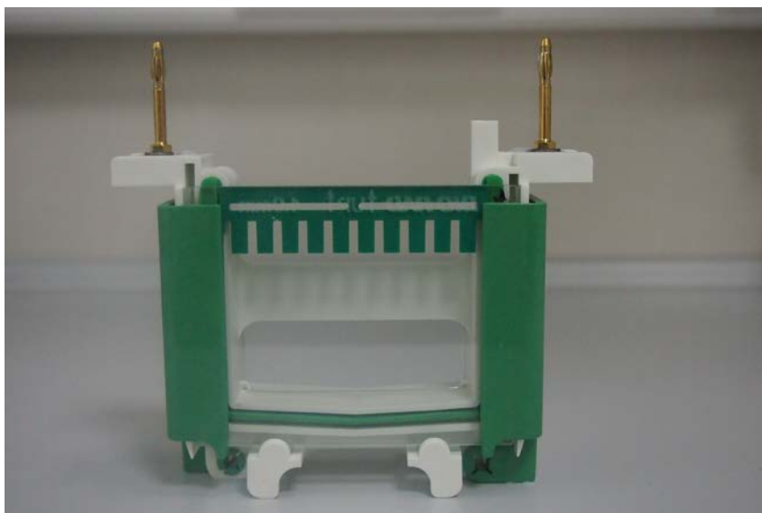
Slika 4.7. Pripremanje gela za SDS-PAGE
