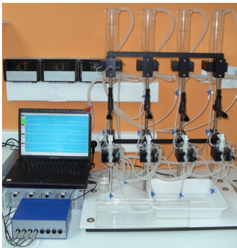
Slika 4.3. Korišteni sustav u kojemu su montirani torakalni aortalni prstenovi za vrijeme ispitivanja vaskularnih odgovora
