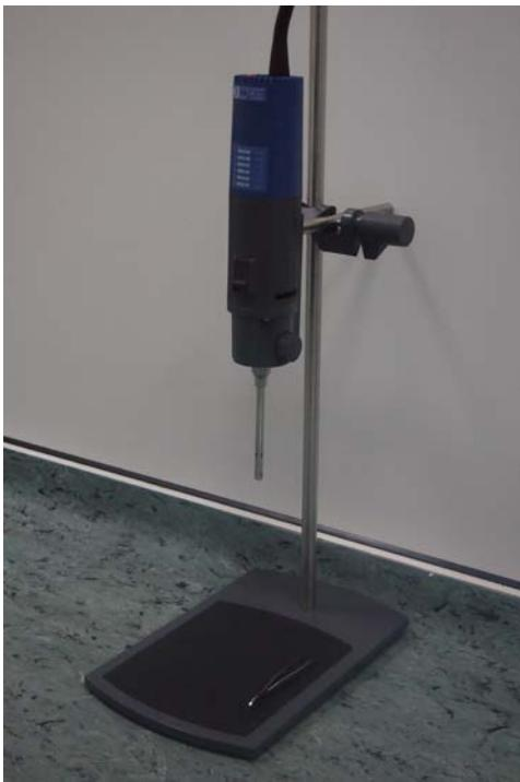
**Slika 4.6.** Homogenizator ULTRA-TURRAX pomoću kojega su pripremani uzorci
