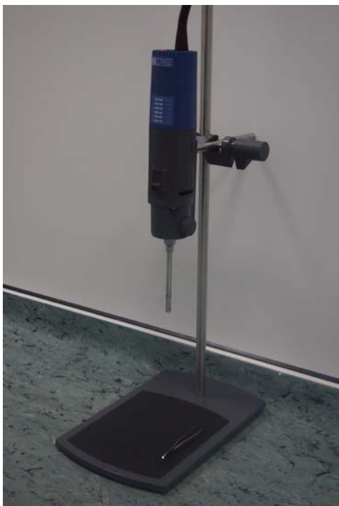
Slika 4.6. Homogenizator ULTRA-TURRAX pomoću kojega su pripremani uzorci
