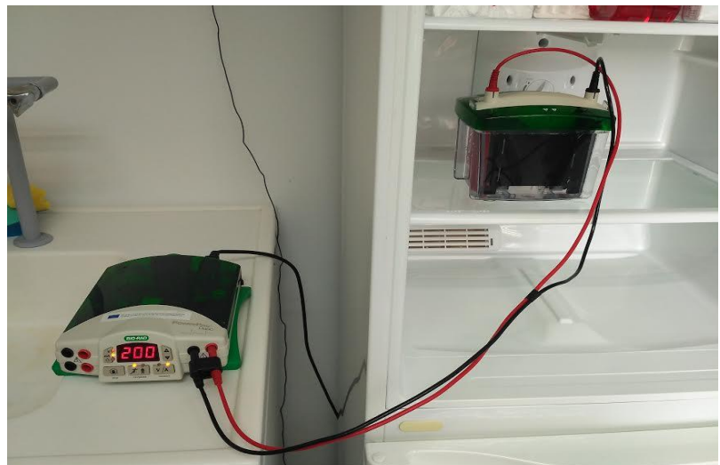
Slika 5. Prikaz procesa prijenosa proteina na membranu pri 200 mA
