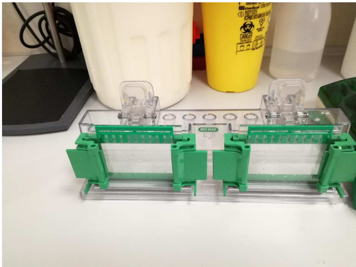
Slika 5. Postavljanje sustava za polimeriziranje gelova za elektroforezu
