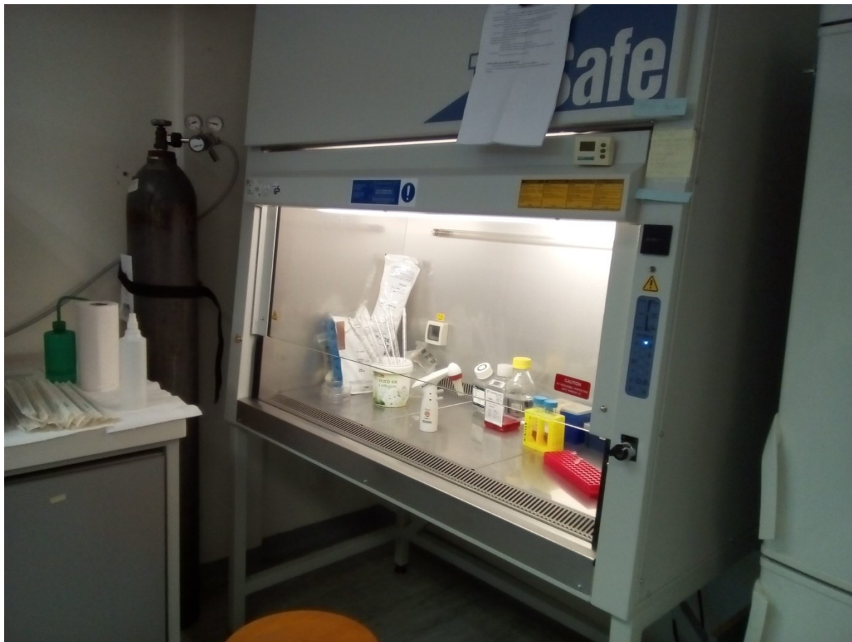
Slika 2 – Radna stanica (tzv. „hood“) korištena u radu sa staničnim kulturama
