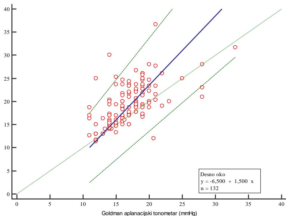
Slika 3. Intraokularni tlak izmjerен Goldmanovim aplanacijskim tonometrom i *air-puff* tonometrom (Passing-Bablokova regresijska analiza) za desno oko
