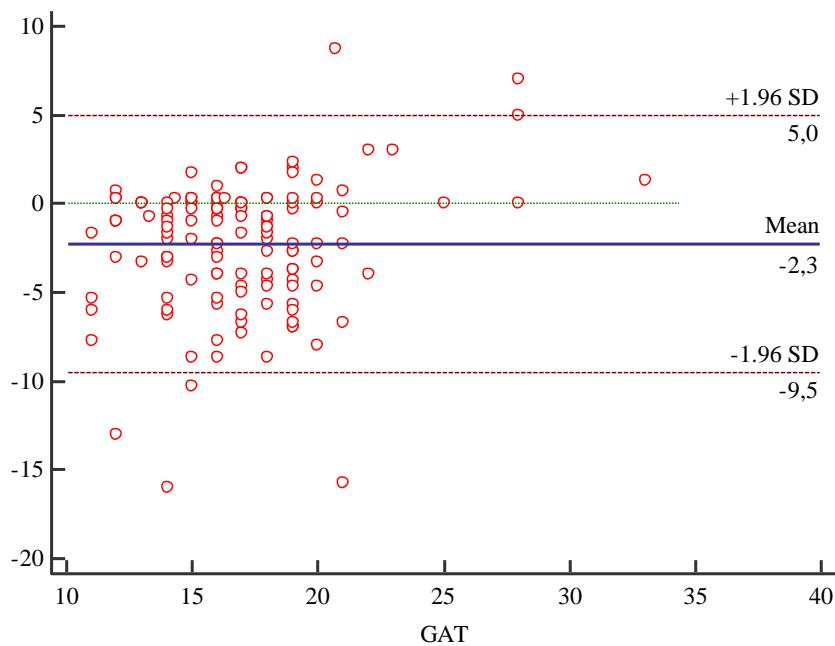
Slika 4. Bland-Altmanova analiza razlike u intraokularnom tlaku desnog oka mjerenoj Goldmanovim aplanacijskim tonometrom (GAT) i *air-puff* tonometrom (Mean – razlika, SD standardna devijacija)
