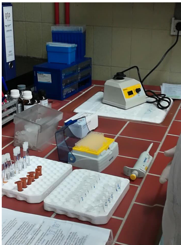
Slika 3: Priprema uzorka za analizu LC-MS/MS metodom
