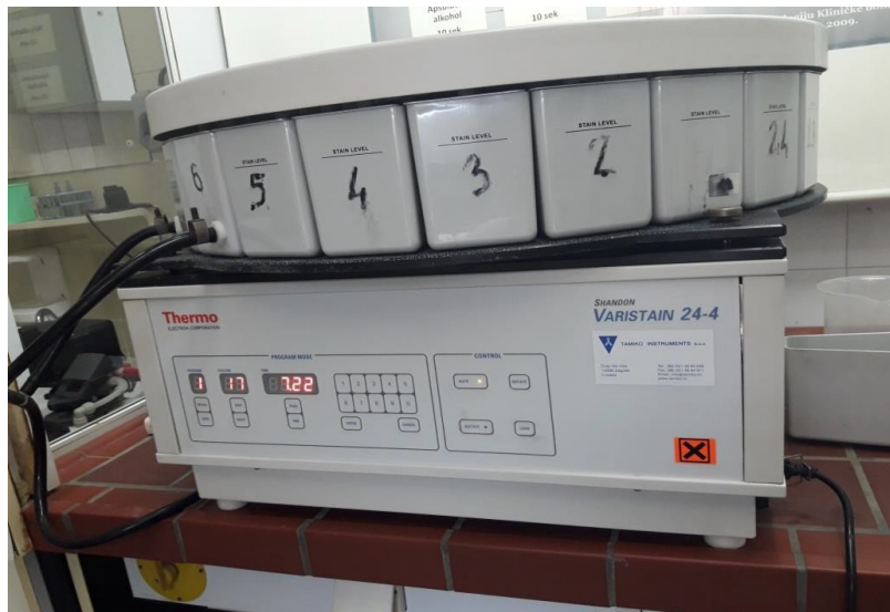
Slika 10. Aparat za bojanje uzoraka metodom po Papanicolaou (iz fundusa Kliničkog zavoda za kliničku citologiju KBC-a Osijek)
