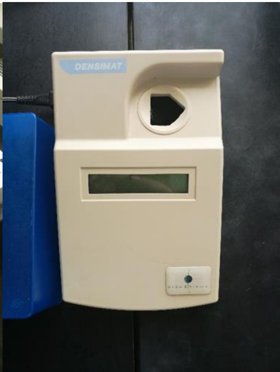
Slika 1. a) Izrada suspenzije zahtijevane optičke gustoće, b) Turbidimetar za mjerenje optičke gustoće medija (fotografirala Vlatka Stojčić, Medicinski fakultet Osijek)
