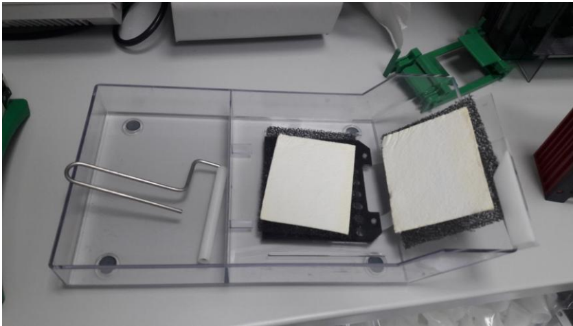
Slika 3. Posuda s puferom i potrebnim komponentama za transfer (izvor: original autorice rada)
