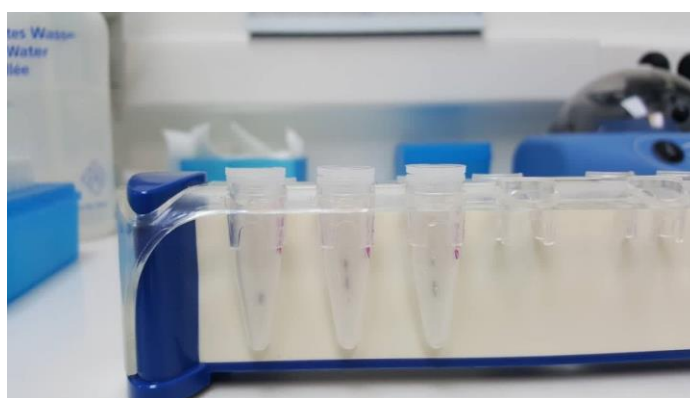
Slika 7. Tubice s uzorkom na magnetskom stalku, ostavljene bez poklopca da se suše na zraku.
