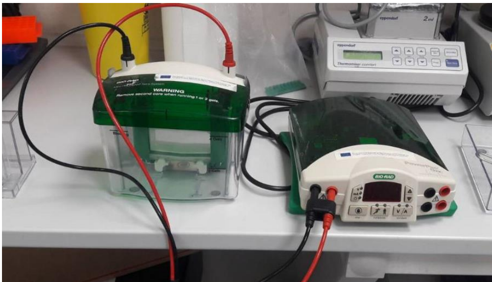
Slika 2. Sustav za elektroforezu (izvor: original autorice rada)
