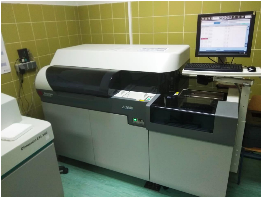
Slika 3. Beckman Coulter AU680 uređaj
